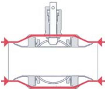
Посредством нашей особой конструкции осевые усилия, возникающие в трубопроводе, воздействуют только на наружную часть корпуса клапана. Усилия не затрагивают жизненно важные части крана и не оказывают воздействия ни на
