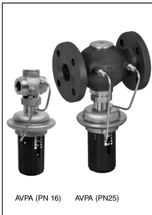
Регулятор AVPA является автоматическим регулятором для сброса избыточного перепада давления и предназначен, главным образом, для использования в системах теплоснабжения. Регулятор нормально закрыт и открывается при возрастании перепада давления.
