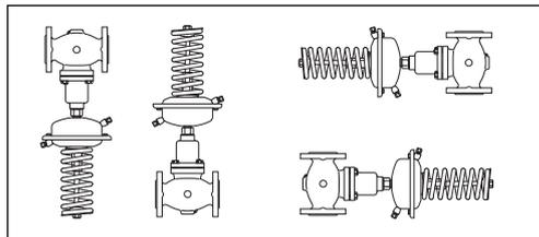
Регуляторы с клапанами DN 100 - 250, или с клапаном любого диаметра при температуре перемещаемой среды выше 120 °С должны быть установлены на горизонтальных трубопроводах регулирующим элементом вниз.
