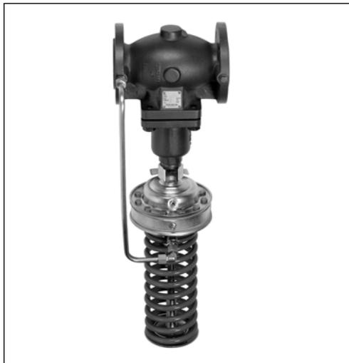
AFP / VFG 2 (VFG 21) является автоматическим регулятором перепада давления для использования в системах централизованного теплоснабжения. При повышении регулируемого перепада давления клапан регулятора закрывается. Регулятор состоит из регулирующего фланцевого клапана, регулирующего элемента с диафрагмой и пружиной для настройки перепада давления.
