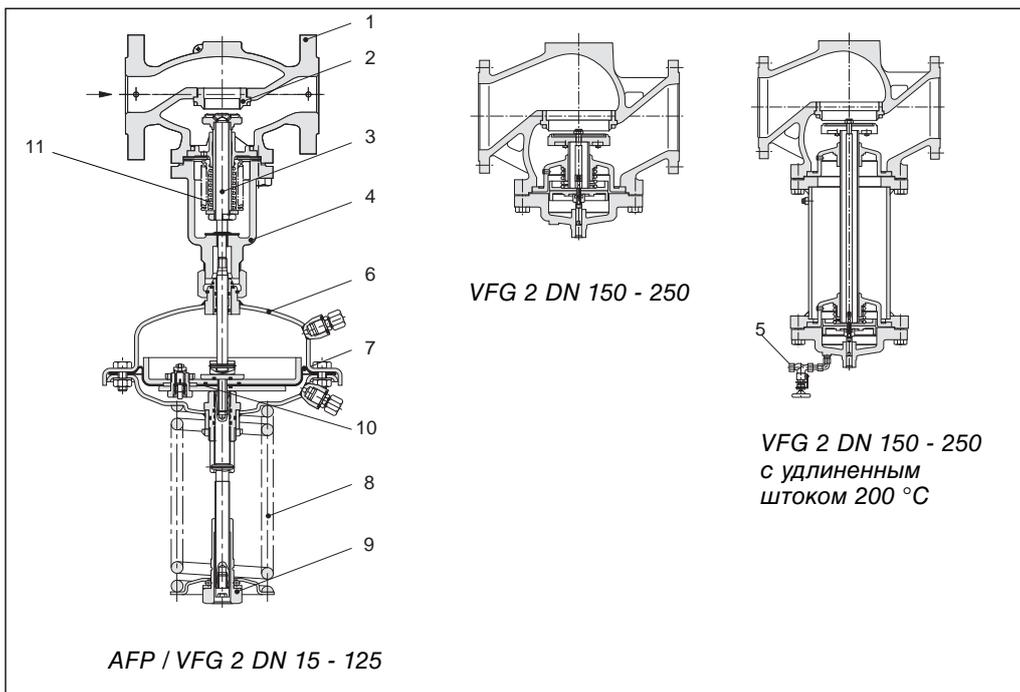
Рост давления в подающем и в обратном трубопроводах будет передаваться через импульсные трубки в регулирующий элемент. При возрастании перепада давления клапан регулятора прикрывается, а при его снижении открывается, поддерживая таким образом
