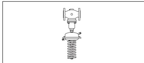
Импульсные трубки должны устанавливаться между подающим или обратным трубопроводом и регулирующим элементом. При использовании перемещаемой среды с температурами от 150 до 200 °С на импульсной трубке, идущей к подающему трубопроводу, должен устанавливаться охладитель импульса давления. В разделе "Принадлежности" представлены импульсные трубки AF, которые могут быть использованы для подключения охладителя. При установке охладителя трубка, как правило, разрезается.
